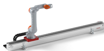
Axe linéaire au sol CoboMover CMF avec cobot KUKA LBR iisy R1300
